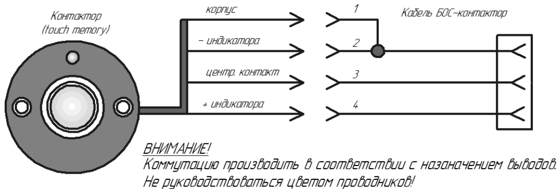
Рисунок 2.4 – Схема подключения контактора
